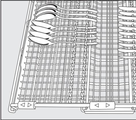
Für ein optimales Reinigungsergebnis ordnen Sie die Löffel mit der Innenseite zur Mitte der Besteckschublade ein.
