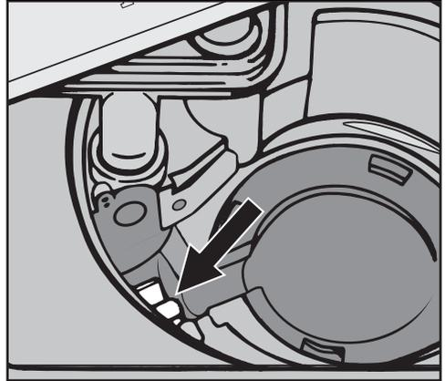
Unter dem Rückschlagventil befindet sich die Ablaufpumpe (Pfeil).
