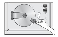
Schieben Sie mit dem Daumen der rechten Hand die Türentriegelung nach vorn und drehen Sie den Griff nach oben.
