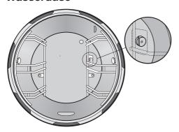
Durch die Wasserdüse hinter dem Abprallblech des rechten Aufnahmegitters wird während der Rückkühlphase Wasser in den Garraum gesprüht. Diese Düse kann nach längerem Einsatz verschmutzen und verkalken.
