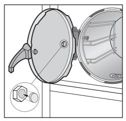
■ Prüfen Sie zuerst, ob die Silikonscheibe aus der Überdrucksicherung herausgedrückt wurde. Wenn das der Fall ist, drücken Sie eine neue Silikonscheibe (siehe Kapitel "Übersicht – Mitgeliefertes Zubehör") in die Öffnung der Überdrucksicherung auf der Innenseite der Gerätetür.
