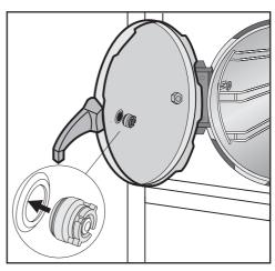
Stecken Sie das neue Sicherheitsventil auf. Achten Sie darauf, dass sich die Gummidichtung dabei richtig einfügt.
