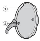
Abhängig von der Gebrauchshäufigkeit müssen die Türdichtung ① und das Sicherheitsventil ② alle 1 bis 2 Jahre ausgewechselt werden. Wechseln Sie beide Teile gleichzeitig aus.
