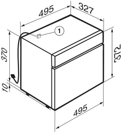
① Netzanschlussleitung – Einführung am Dampfgarer
